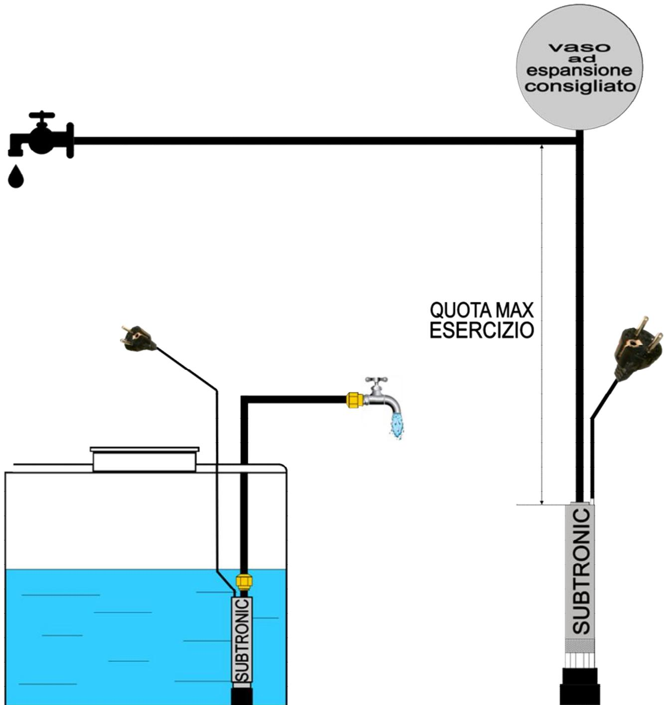
installazione all'interno di serbatoio di raccolta
