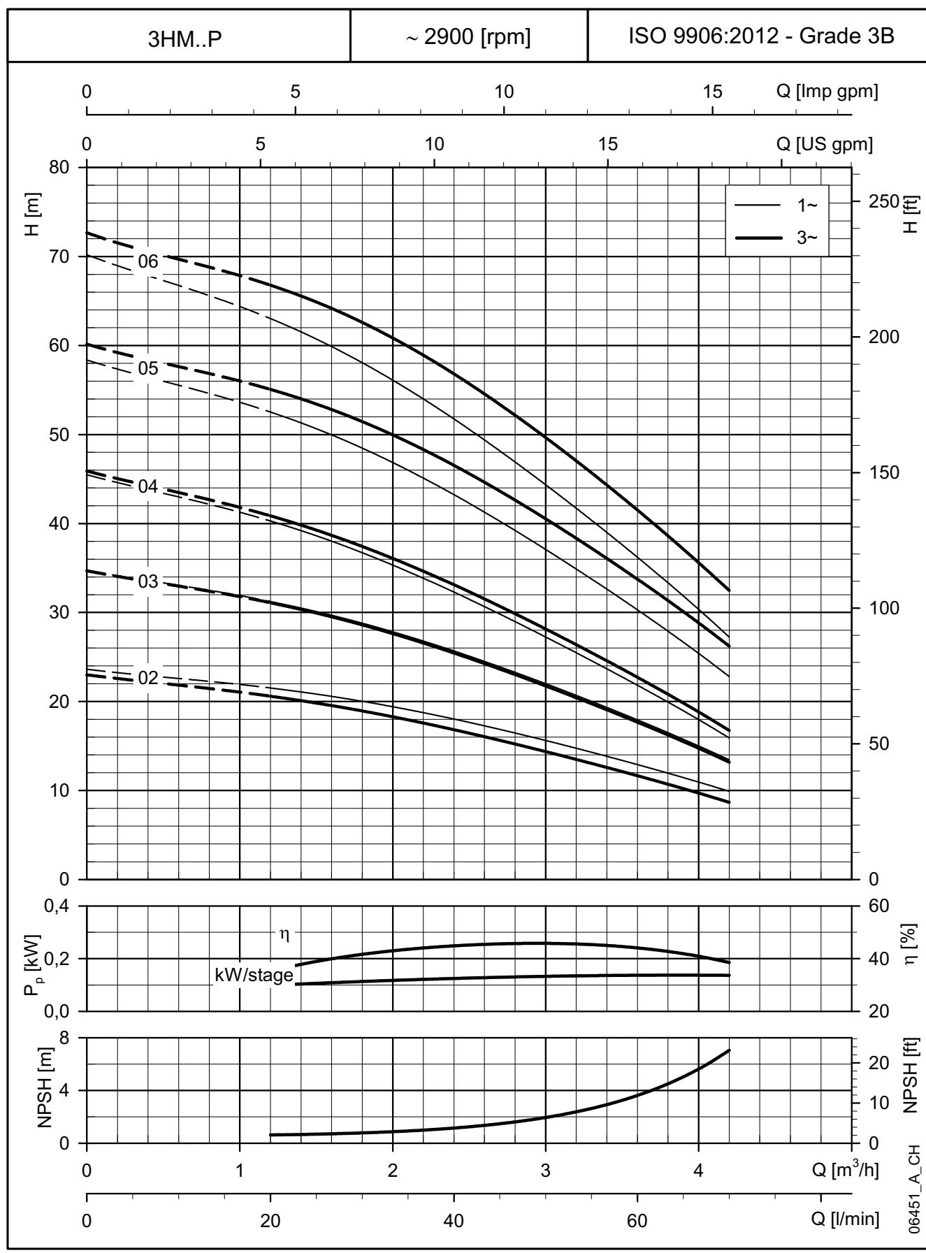
Le prestazioni valgono per liquidi con densità  $\rho = 1.0 \text{ Kg/dm}^3$  ed una viscosità cinematica  $\nu = 1 \text{ mm}^2/\text{sec}$ .
