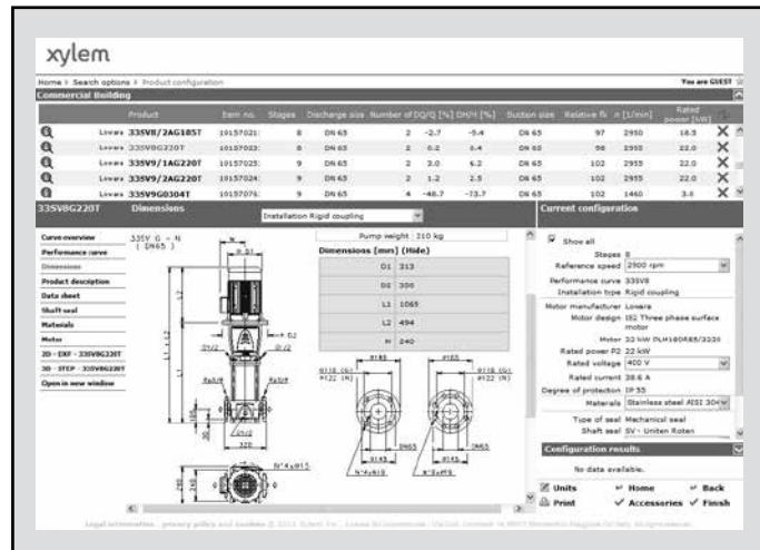
I disegni dimensionali vengono visualizzati sullo schermo e possono essere scaricati in formato .dxf
