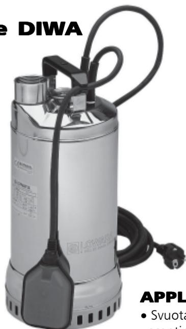
Pompe sommergibili per acque chiare o leggermente sporche completamente in acciaio inossidabile AISI 304. Prevalenze fino a 20 m, portate fino a 420 l/min (25,2 m<sup>3</sup>/h). Quattro versioni base con potenza nominale da 0,55 a 1,5 kW. Sistema di tenuta **DRIVELUB SEAL SYSTEM**. Piatto di rasamento rivestito con elastomero poliuretano: massima resistenza all'abrasione.
