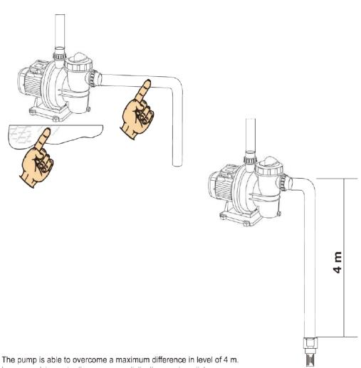
پمپ را به صورت افقی نصب کنید تا جایی که امکان دارد نز دیک لبه استخر باشد .
